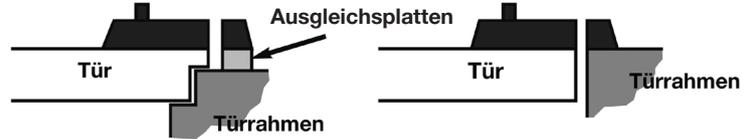
6. Setzen Sie das Kastenzusatzschloss - mit der Türkante abschließend - auf die Montageplatte und befestigen Sie es seitlich mit den Gewindeschrauben.
